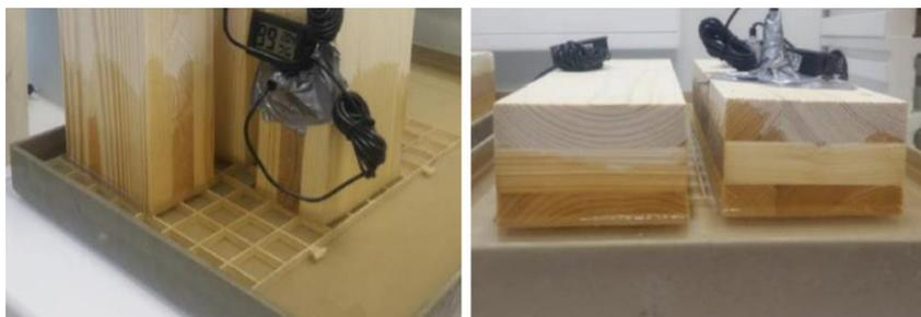
Fig. 2 - Assorbimento d'acqua per capillarità in elementi verticali (a sinistra) e in elementi orizzontali (a destra)
