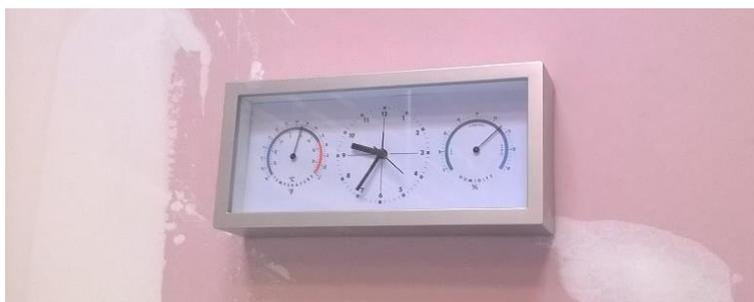
Fig. 18 - Controllo della temperatura e dell'umidità interna in cantiere mediante termoigrometro
