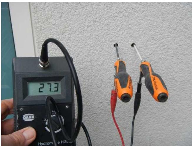
Misura di umidità su di una parete in legno con elettrodi lunghi e isolati che attraversano il cappotto
