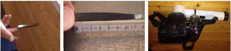
*Strumenti di rilevazione delle fessure: spessimetro, metro e lente di ingrandimento munita di fotocamera*
