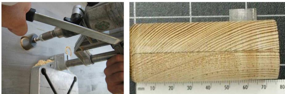
*Prelievo di legno lamellare per l'esecuzione di una prova a taglio lungo la linea di colla*
