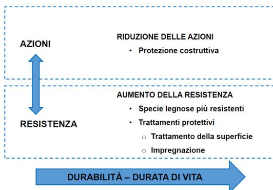
*Schema che illustra le modalità per aumentare la durabilità dell'opera: ridurre le azioni ed aumentare la resistenza*
