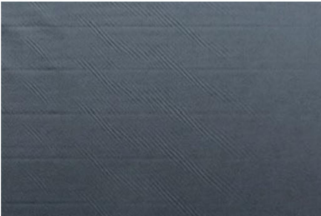
**Figura 9.4.4** Le impronte trasversali attraverso il collegamento con il rullo di avvolgimento e le cuciture trasversali che appaiono possono essere visibili nel tessuto, vedi 4.2.7
