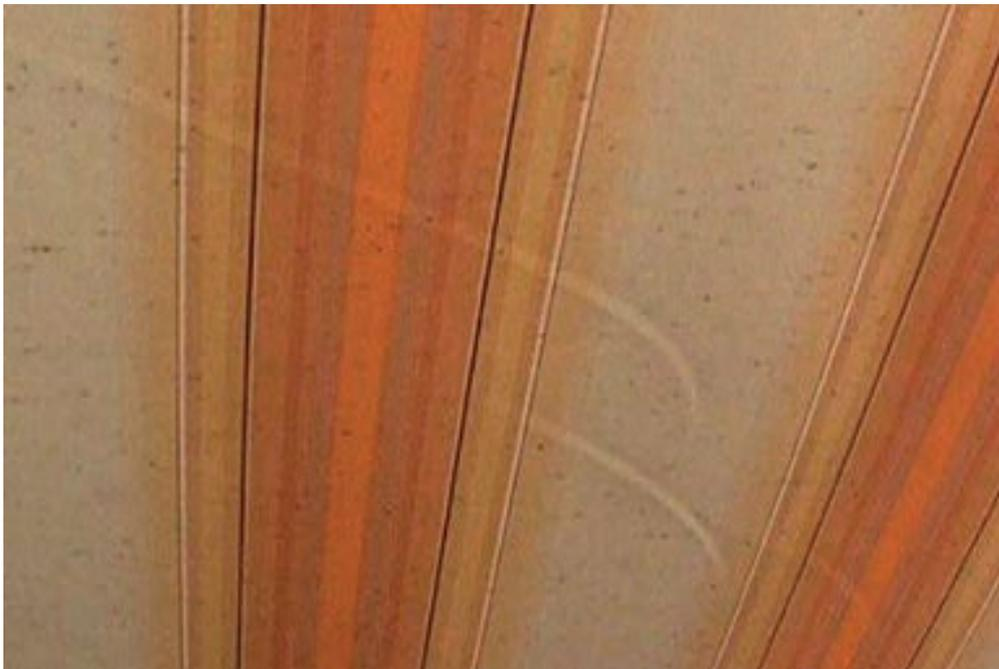
**Figura 9.13** Rappresentazione della sovrapposizione delle pieghe di avvolgimento
