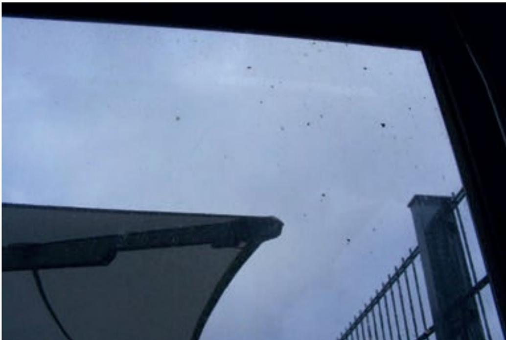
**Figura 9.4.5** Sulla finestra di visualizzazione del PVC possono comparire segni di abrasione e graffi e possono formarsi strisce orizzontali. Le cariche elettrostatiche possono verificarsi più frequentemente e portare ad un aumento del numero di attrazione di particelle di sporco.
