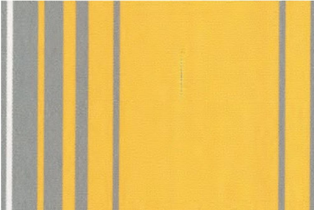
**Figura 9.1.1 Rottura consentita della filettatura corta connessa con la trasmissione della luce**
