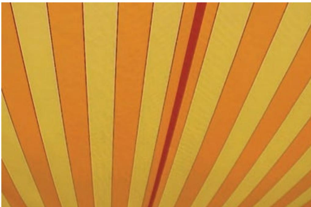
**Figura 9.1.8 Ondulazione/Incrispatura consentita nell'area delle cuciture (formazione a nido d'ape)**
