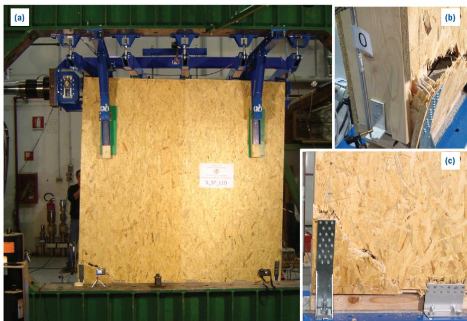
Figura 1.13. (a) Prove sperimentali di pareti intalate condotte presso il laboratorio prove Materiali e Strutture dell'Università di Trento; (b) rottura per strappo del dispositivo di ancoraggio a terra; (c) sollevamento della parete per cedimento dell'ancoraggio di base e apertura del pannello di rivestimento della parete
