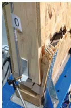
**Figura 1.18. (a) Rottura fragile dell'hold-down a livello della sezione netta; (b) strappo della chiodatura dell'hold-down di base per sopraggiunta capacità massima**
