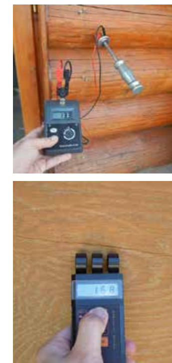
Figura 2.7 – Igrometro a chiodi (a “resistenza”) e a contatto (a “capacità”).
