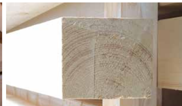
Figura 3.13 – Canastro sulla sezione trasversale, riconoscibile per il colore bruno che segue gli anelli di accrescimento.
