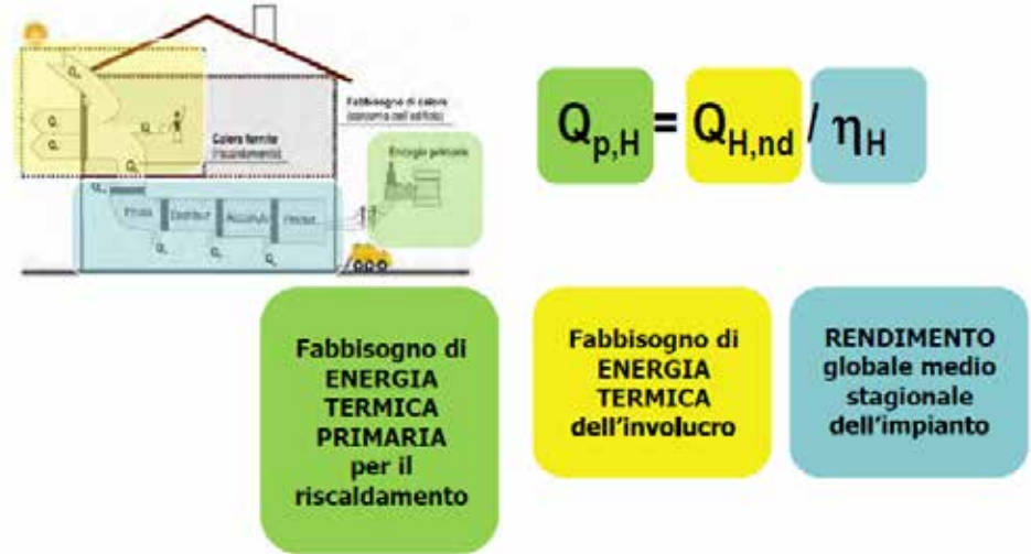
Figura 8.61 - Conoscendo i rendimenti impiantistici \eta_H ed i coefficienti di conversione tra energia utile e primaria, si può ottenere il Fabbisogno di energia primaria.
