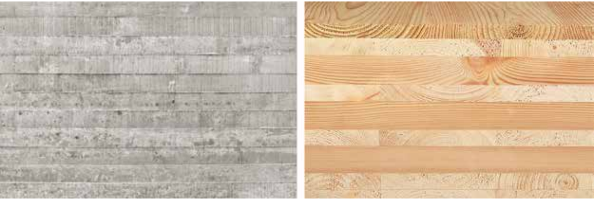
Figura 8.14 – Il legno e il cemento armato hanno entrambi una ottima capacità "teorica" di accumulare calore nel lungo periodo, ma il primo ha una risposta più dinamica e rapida agli sbalzi di temperatura.
