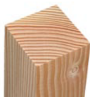
Figura 4.2 – Campione di legno di conifera dove è ben visibile la zona tardiva degli anelli di accrescimento (courtesy CNR IVALS).
