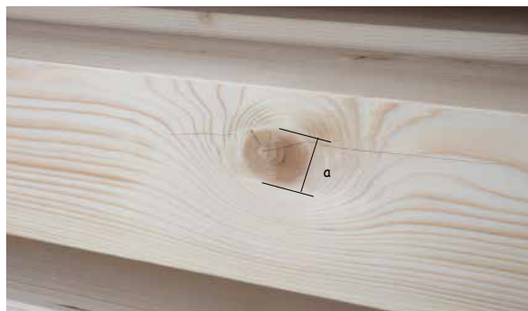
Figura 3.8 - Nodo singolo sulla faccia.
