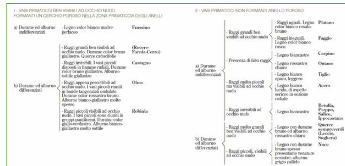
Figura 4.5 - Chiave dicotomica per legni di Latifoglia (courtesy CNR IVALS).
