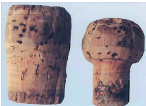
Figura C.19 – Forma del turacciolo al momento della sua estrazione dalla bottiglia (destra) e dopo il test di bollitura (sinistra).
