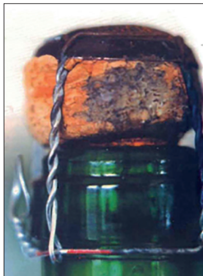
Figura C.20 – Errato posizionamento della gabbietta non vincolata sotto la бага. Il tappo non è ben assestato sul raso bocca e presenta evidenti segni di trafilamento del prodotto e di sviluppo di muffe.
