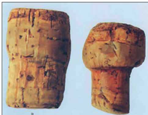
Figura C.18 – Forma del turacciolo al momento della sua estrazione dalla bottiglia (destra) e dopo il test di bollitura (sinistra).
