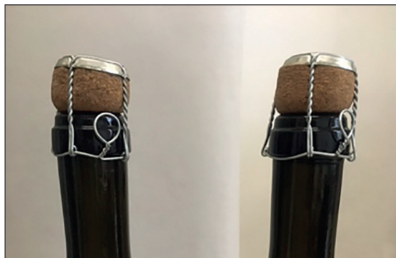
Figura C.17 – Ancoraggio non corretto della gabbietta dovuto allo scarso affondamento.
