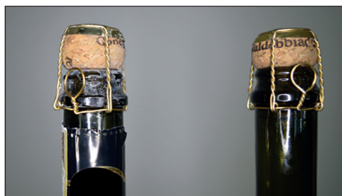
Figura C.10 – Trafilamento spumante per mancanza "effetto tappo corona" dovuto a difetto di gabbiettatura.
