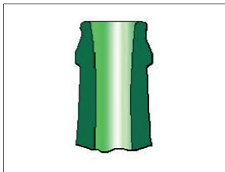
Figura C.15 – Collo della bottiglia con conicità inversa.
