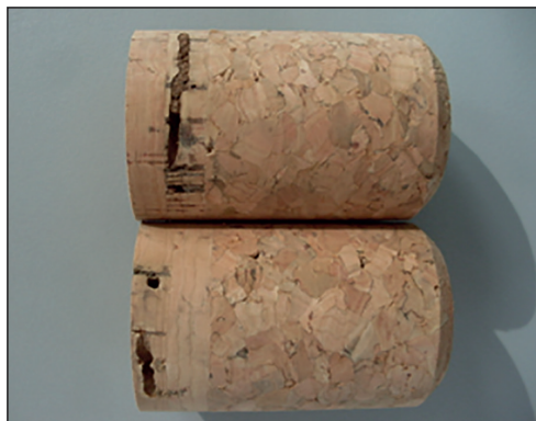
Figura B.4 – Sughero con gallerie di insetto.
