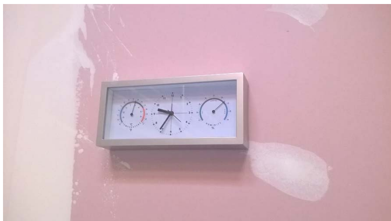
Figura 6.4 Controllo della temperatura e dell'umidità in cantiere tramite termoigrometro
