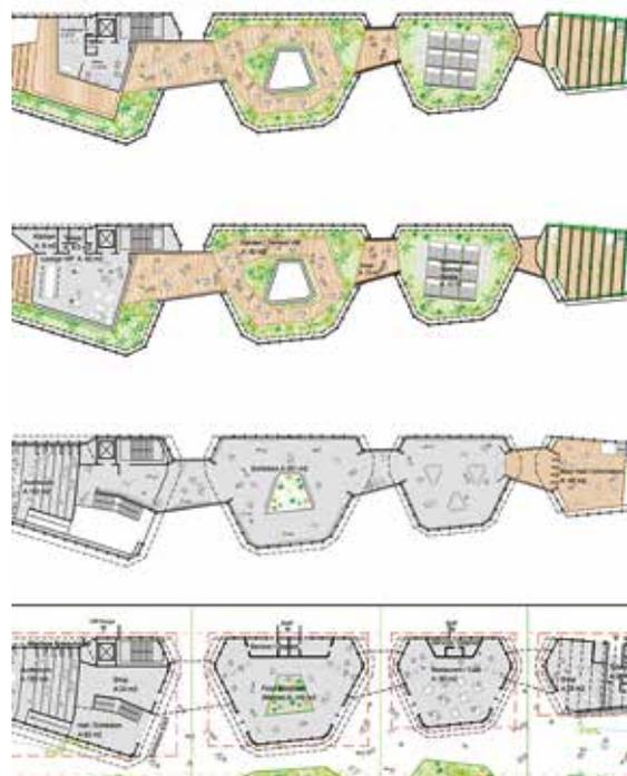
composta da moduli/edifici, su più piani, ognuno dei quali rappresenta una zona climatica differente. La peculiarità della costruzione è data da una struttura in legno lamellare costruita interamente a secco, formata da pilastri, solai, scale e tamponamenti. L'originalità del progetto sta nella forma particolare dei 4 moduli, costruiti a forma di cesto o a botte e collegata da ponti. La complessità si è evidenziata durante le fasi di montaggio
