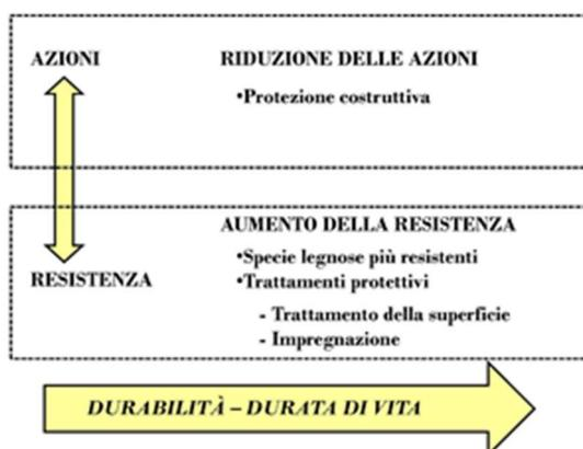
Fig. 4.1- Strategie di progetto per aumentare la durabilità della costruzione
