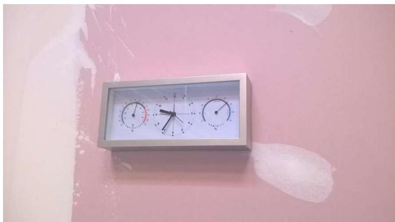
Fig. 6.11 – Controllo della temperatura e dell'umidità interna in cantiere mediante termigrometro.
