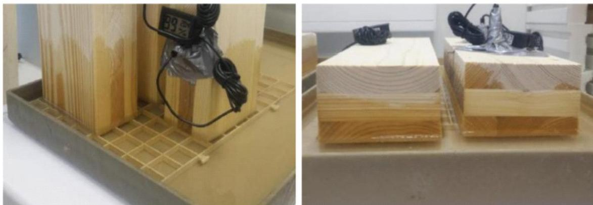
Fig. 4.8 – Esempio - assorbimento d'acqua per capillarità di elementi verticali (fig. a sinistra); assorbimento d'acqua per capillarità di elementi orizzontali
