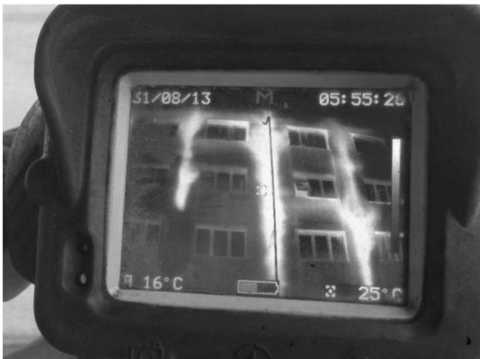
Fig. 6.17 – Immagine termografica – sviluppo e propagazione dell'incendio attraverso i cavedi tra moduli prefabbricati
