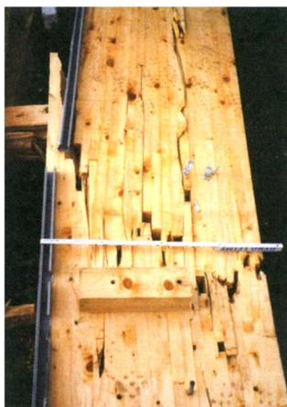
Fig. 6.5 – Rottura di un elemento in legno lamellare dovuto ad una bassa qualità realizzativa del giunto a dita. La linea di rottura coincide con la presenza lungo il profilo dell'elemento di giunti a dita.
