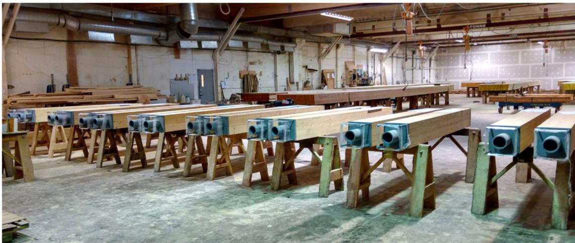
Fig. 7.8 – Installazione delle piastre metalliche sugli elementi verticali in legno dell'opera (Courtesy British Columbia)
