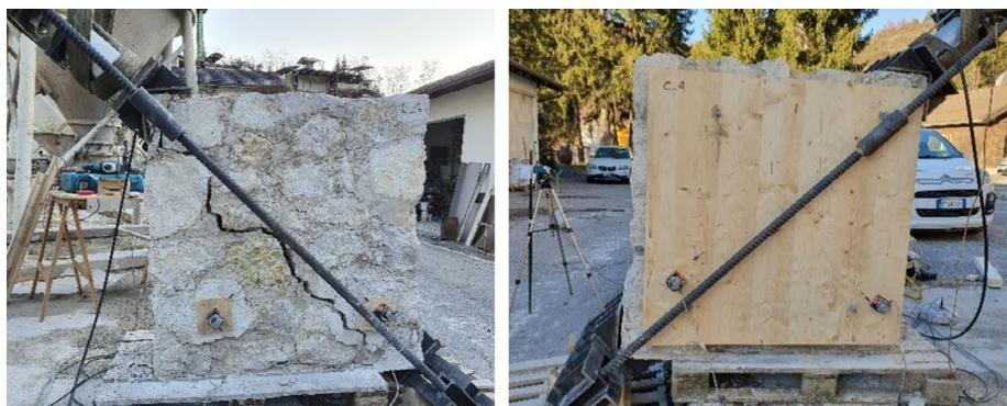
Fig. 40 - Rinforzo di edifici in muratura con elementi di legno. Prove di compressione diagonale su campioni di muratura di pietra rinforzati con pannelli X-LAM collegati con barre resinatizzate; sx.: campione non rinforzato; dx.: campione rinforzato [22].
