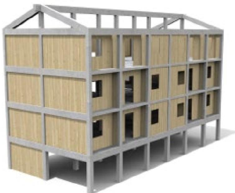
Fig. 44 - Possibile utilizzo dei sistemi costruttivi in legno all'interno di costruzioni a telaio in calcestruzzo
