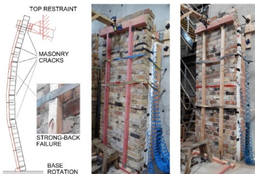
Fig. 38 - Rinforzo di edifici in muratura con elementi di legno. Test di pareti rinforzate con costolature (strong-back) lignee. Attività di ricerca in collaborazione con l'Università di Auckland (NZ) [19].
