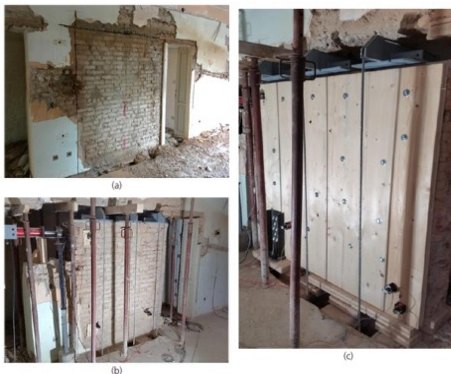
Fig. 41 - Rinforzo di edifici in muratura con elementi di legno. Test sperimentali su pareti in muratura rinforzate con pannellature lignee. Test condotti presso l'ex Grande Albergo Terme delle Terme di Comano (TN); (a) preparazione della parete; (b) parete non rinforzata, pronta per essere testata; (c) parete rinforzata con pannello X-LAM [23]
