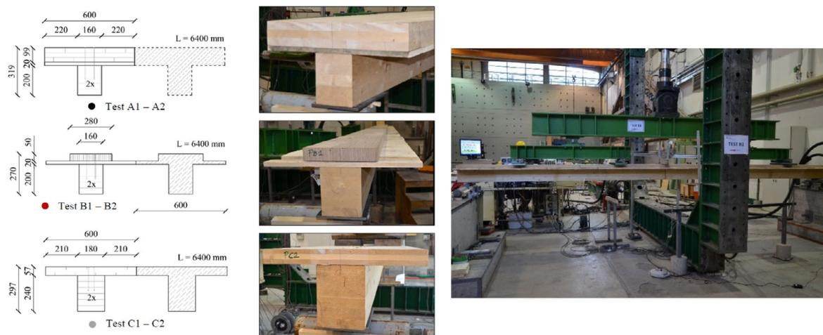
Fig. 37 - Rinforzo di solai lignei esistenti con metodi compositi legno-legno. Campagna di test condotta presso il LPMS [15].
