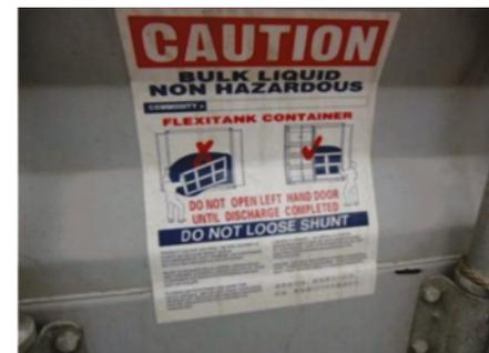
■ Fig. 51 - Etichetta di avviso per flexitank
