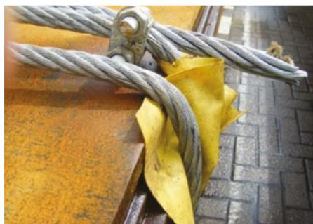
■ Fig. 11 - Protezione per spigoli insufficiente
