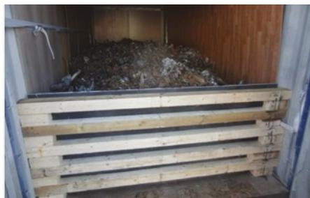
■ Fig. 54 - CTU caricata di rottami con rivestimenti alle pareti e barriera per la porta
