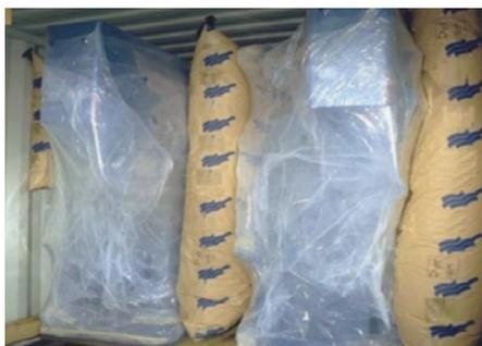
Fig. 10 - Colli dalle forme irregolari bloccati con dunnage bag
