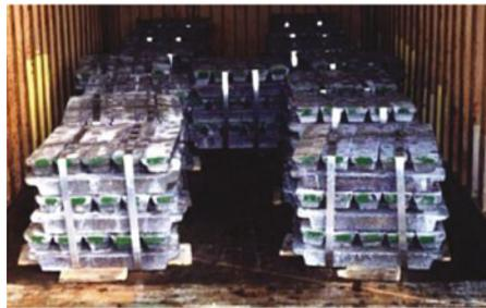
Fig. 19 - Lingotti di metallo unitizzati con reggette di metallo (fissaggio non completato)
