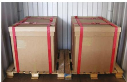
Fig. 8 - Merce saldamente fissata a pallet con cinghie in tessuto
