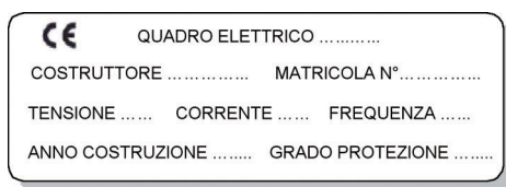
Fig. 4.5 Esempio di targa per un quadro elettrico.
