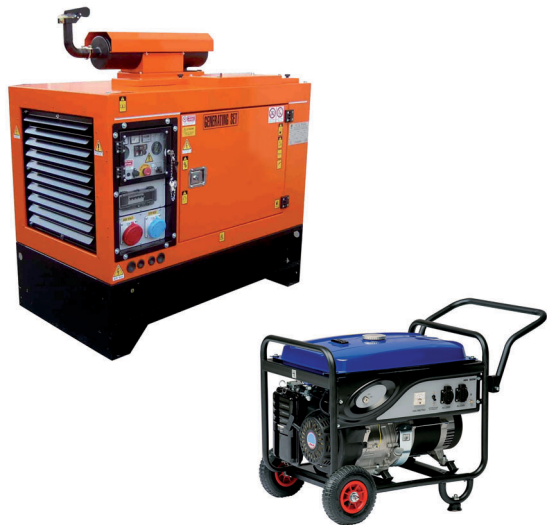
Fig. 2.2 Gruppi elettrogeni: a basamento (a sinistra), di medie dimensioni, e portatile, di piccole dimensioni, montato su carrello. Sono connessi con sistema TN o sistema IT.
