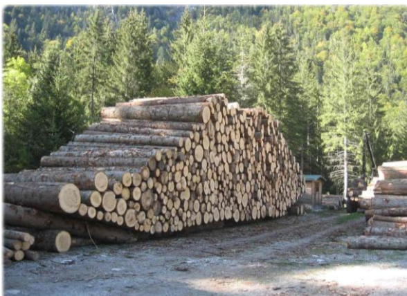
Figura 62 e 63 - Sistemi di accatastamento non lineari con diversi sistemi di sostegno per evitare il rotolamento accidentale dei tronchi
