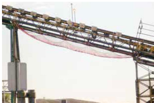
Figura 104 - Esempi di protezione tramite reti delle zone di transito sottostanti i nastri trasportatori.
