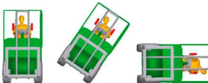
Figura 122 – Ribaltamento di carrello elevatore e trattenuta dell'operato all'interno del volume di sicurezza
