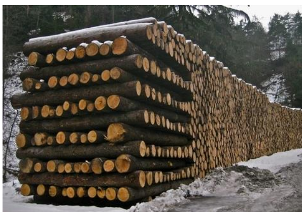
Figura 60 - Sistema di accatastamento lineare
