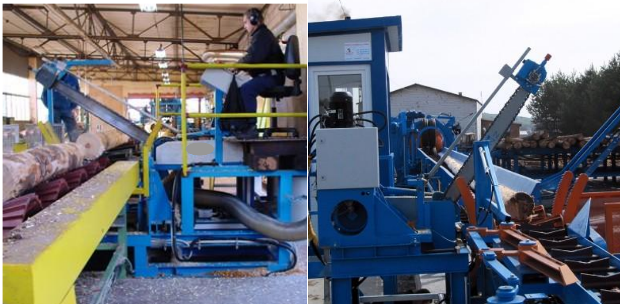
Figura 87 e 88 - Intestatrice-troncatrice tronchi con lama a catena sgorbia e cabina di comando e intestatrice-troncatrice tronchi con lama a catena sgorbia senza cabina di comando
