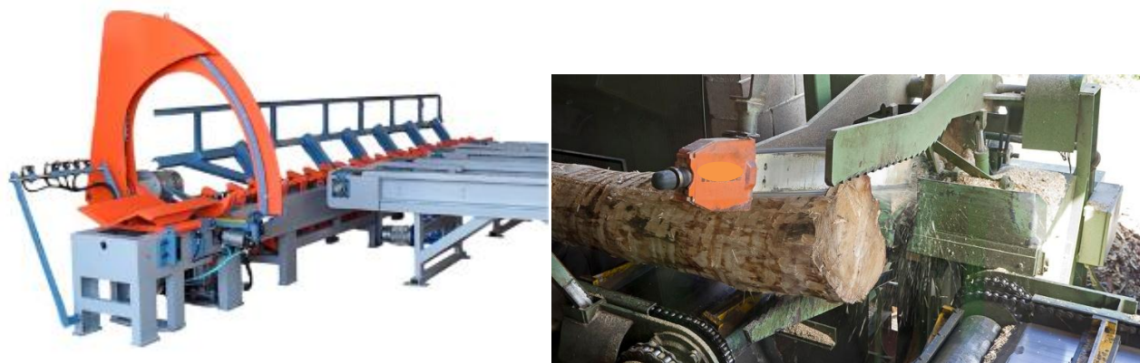
Figure 89 e 90 - Intestatrice-troncatrice tronchi con protezione della lama a catena sgorbia. Particolare della lama a catena sgorbia durante il sezionamento trasversale del tronco.
