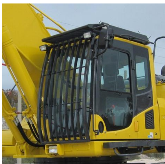
Figura 48 - Cabina di comando dotata di griglia di protezione
