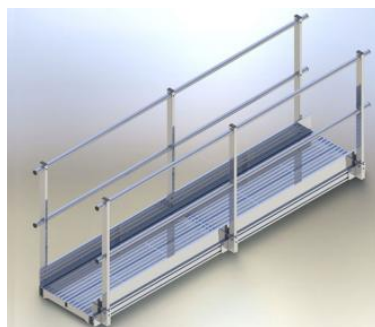
Figura 141 – Esempio di passerella con parapetti laterali e tavola fermapiede.
