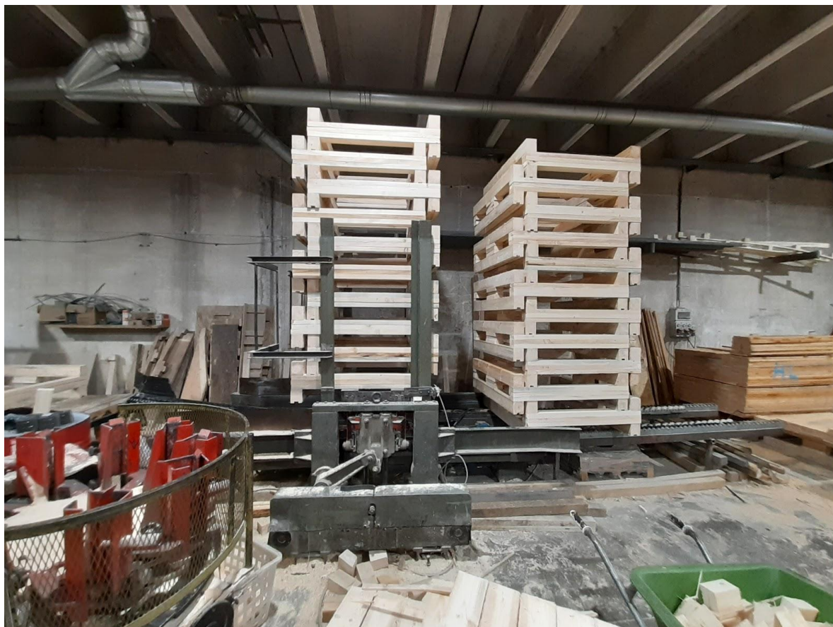
Figura 111 – Esempio di macchina in grado di creare delle cataste di pallet. Un dispositivo alzatore, al centro, è in grado di alzare la catasta e, tramite un nastro trasportatore, inserire un pallet al di sotto della stessa. Viene così ripetuto il ciclo fino ad ottenere l'altezza di catasta desiderata.
