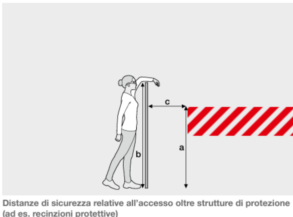
Figura 32 – Rappresentazione struttura di protezione come una recinzione e relative misure da prendere in considerazione per il loro dimensionamento (valori a, b e c) – Fonte: SUVA 2016
