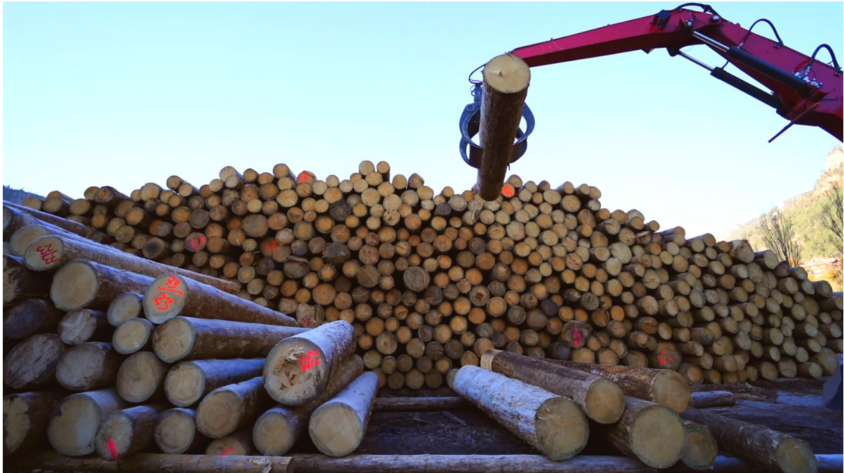
Figura 25 - Stoccaggio di legname all'esterno dell'unità produttiva con successiva selezione e trasporto con apposita macchina di movimentazione.
