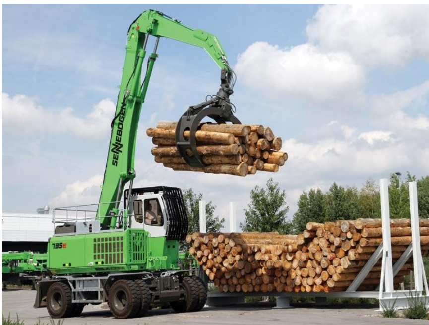
Figura 49 – Esempio di una movimentazione di tronchi tramite pinza per tronchi installata su mezzo specifico.
