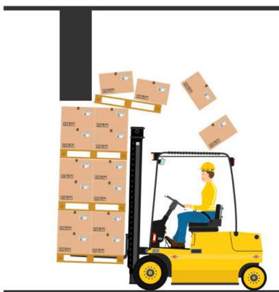
Figura 123 – Esempio di caduta carico trasporta mediante carrello elevatore in seguito ad urto con strutture ambientali.
