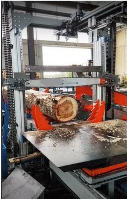
Figura 91 e 92- Intestatrice-troncatrice tronchi con lama a catena sgorbia orizzontale. Intestatrice-troncatrice tronchi con lama a catena sgorbia verticale
