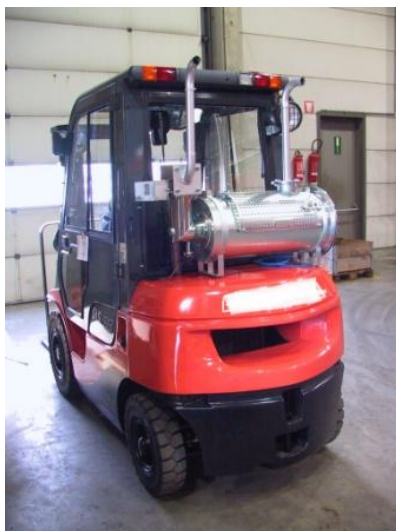
Figura 130 – Esempio di catalizzatore installato su carrello elevatore alimentato a gasolio, al fine di ridurre le emissioni in ambienti interni.
