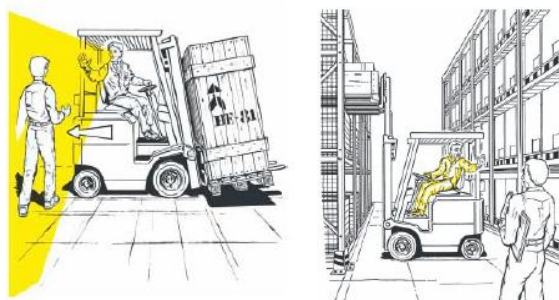
Figura 137 – Comunicazione da parte del carrellista con eventuali persone nel raggio d'azione del mezzo condotto.
