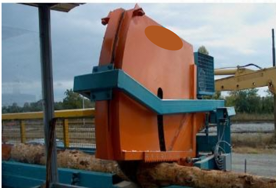
Figura 83 - Particolare della lama circolare per intestatura tronchi con protezione del disco
