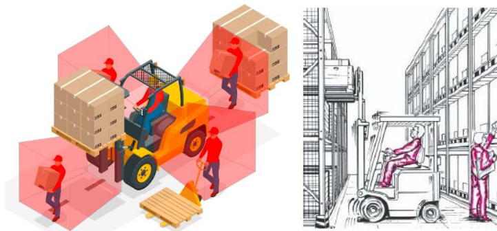
Figura 131 e 132 – Possibili investimenti o urti contro persone durante la movimentazione di carichi con carrelli elevatori.
