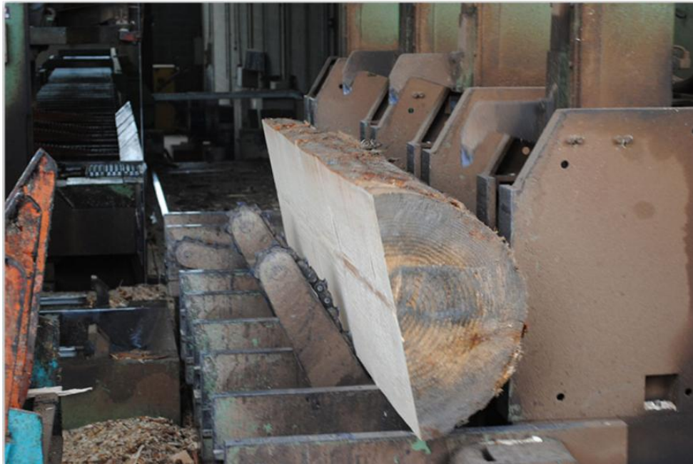
Figura 94 - Particolare di un carro di una macchina sega tronchi
