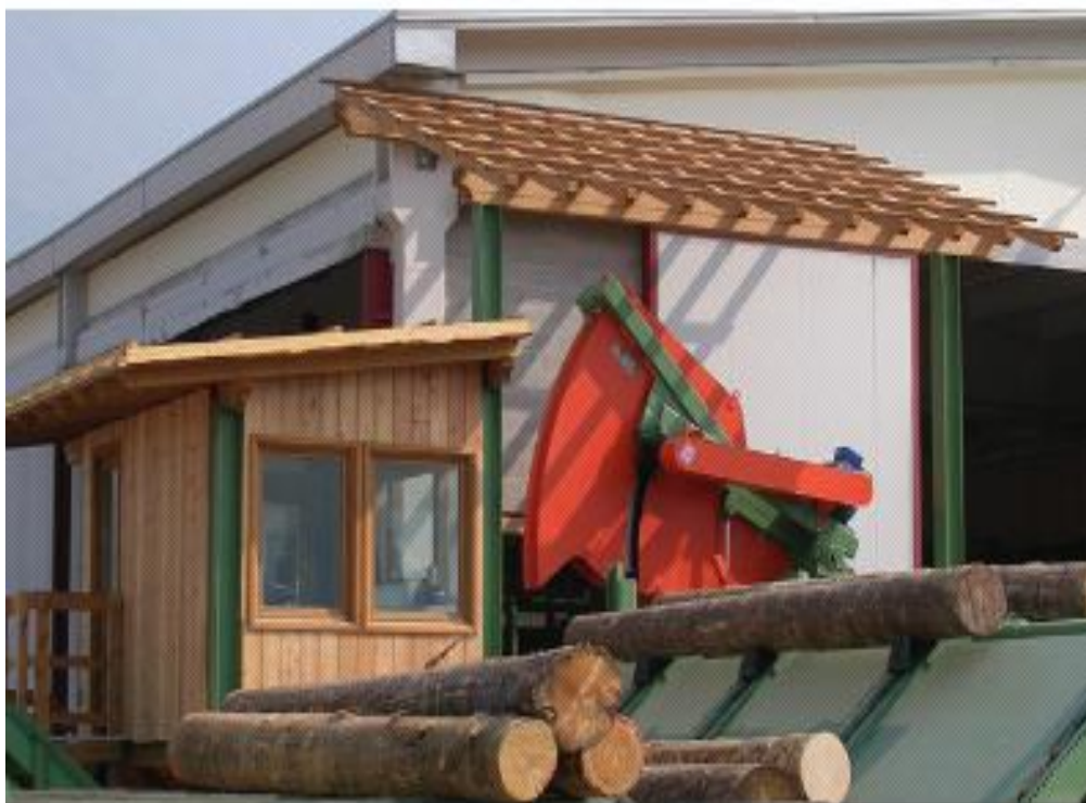
Figura 82 - Intestatrice per tronchi con lama circolare e relativa cabina di comando
