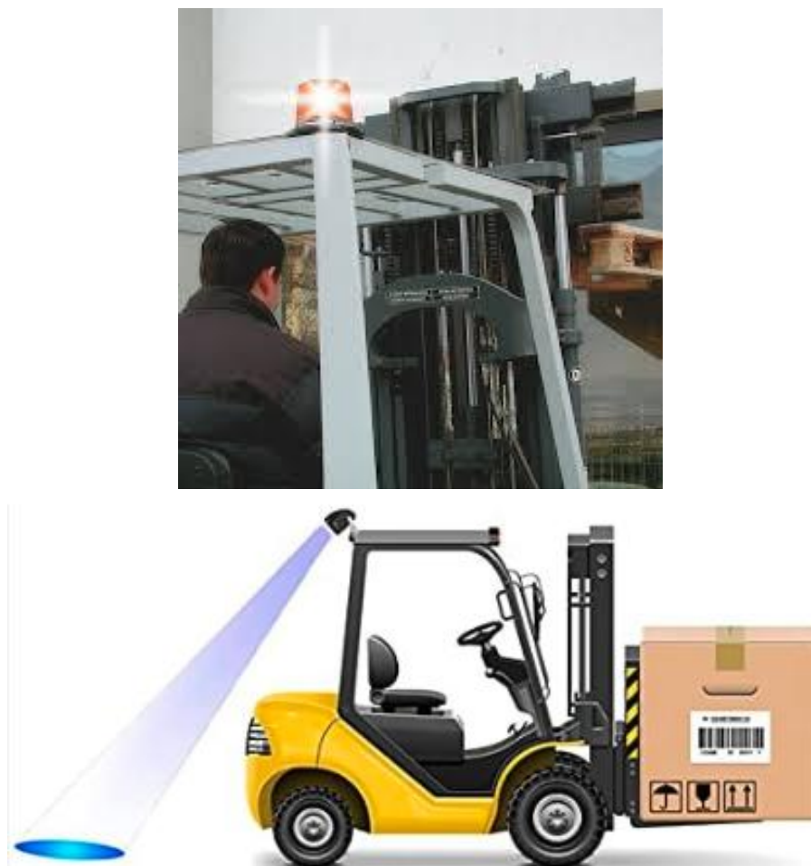
Figura 127 e 128 – Esempi di segnalatore visivo (girofarò) e faro di sicurezza proiettante luce blu sulla pavimentazione, al fine di avvertire dell'imminente passaggio del carrello elevatore in retromarcia.
