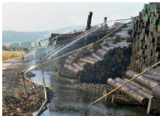
Foto 69 - Cataste irrigate con getti d'acqua
