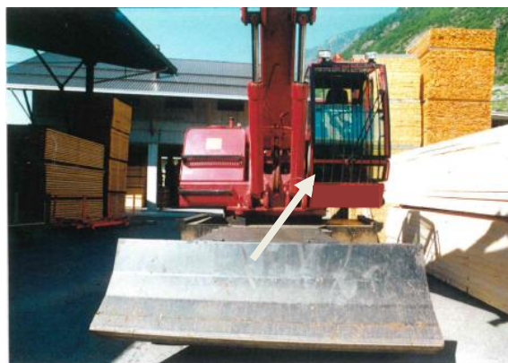
Figura 45 e 46 - Gru con esempi diversi di sistemi di protezione della cabina di comando
