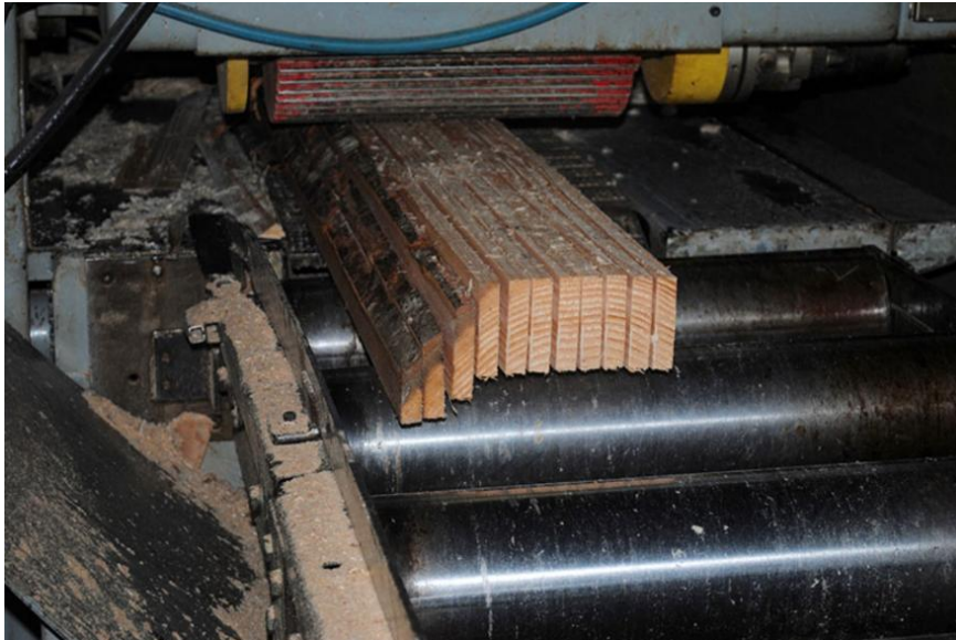
Figura 27 – Semilavorati in legno in uscita da una macchina multilame.
