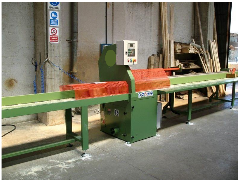
Figura 107 - Esempio Troncatrice automatica con disco di taglio dal basso, protezione della lama con tunnel grigliato fisso (in rosso)
