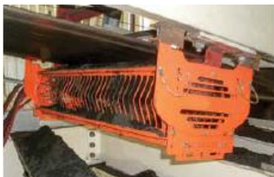
Figura 101 - Esempio protezione su rullo di trasmissione di un nastro trasportatore.
