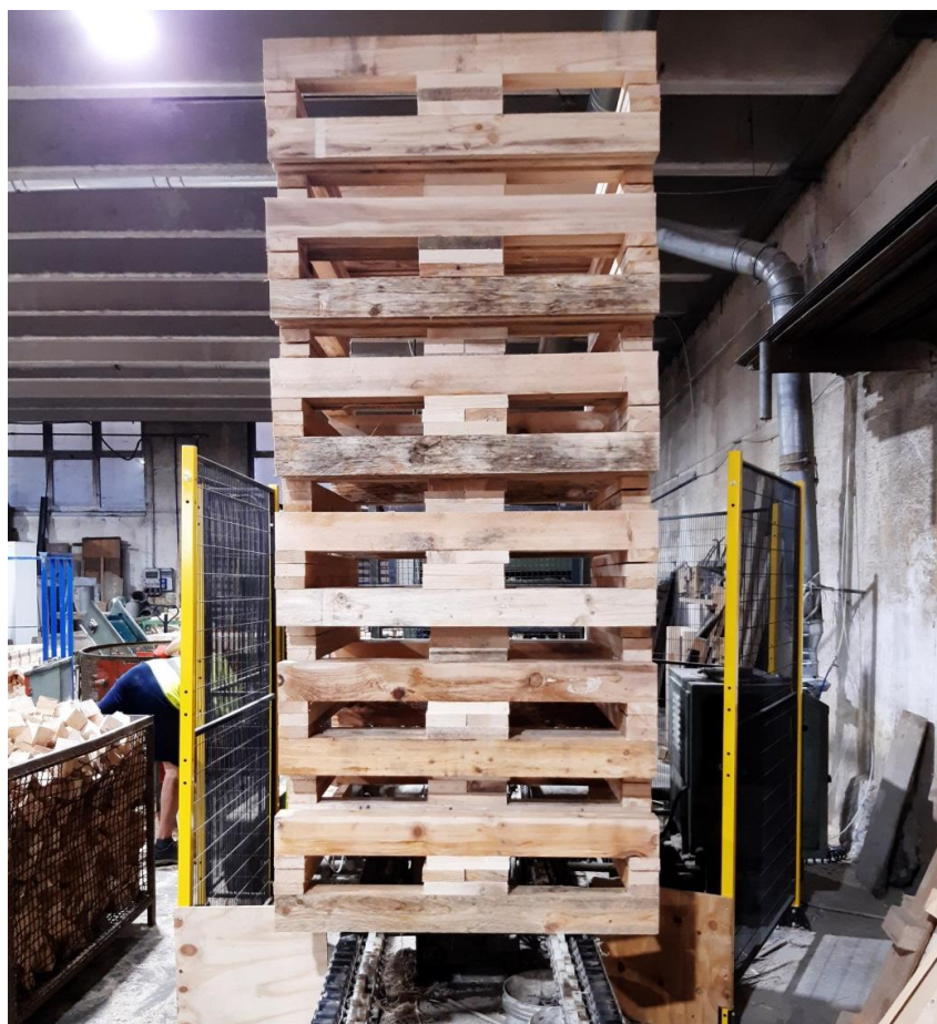
Figura 29 - Catasta di pallet assemblati in uscita dalla macchina chiodatrice semi automatica. Un operatore provvedere successivamente al prelievo della stessa ad opera di carrello elevatore.
