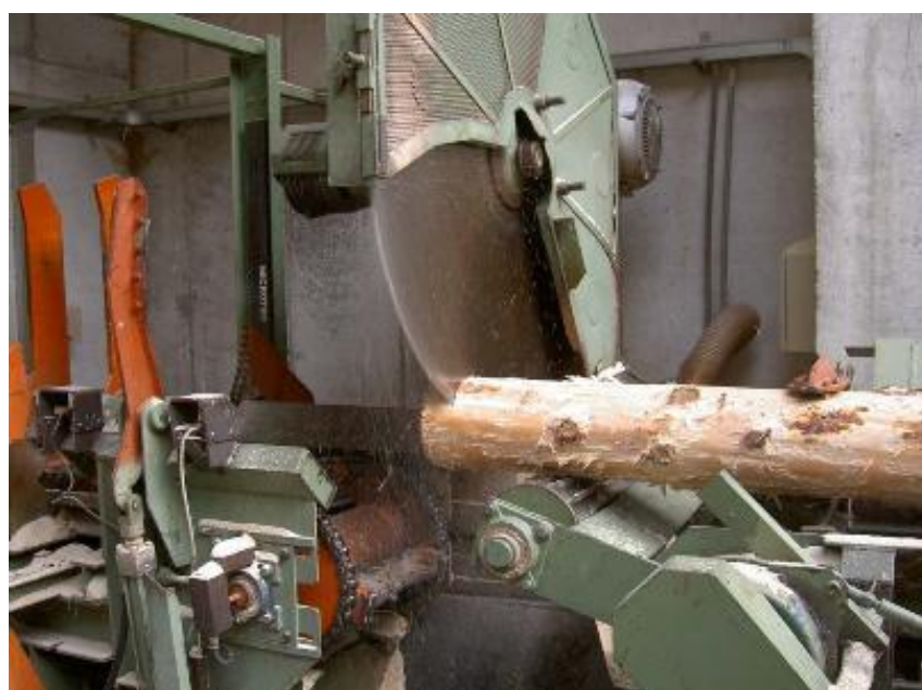
Figura 83 - Particolare della lama circolare per intestatura tronchi con protezione del disco
