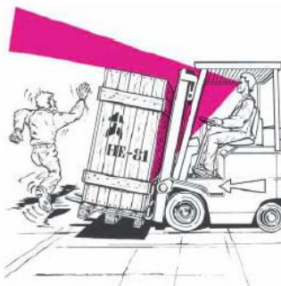
Figura 133 – Rischio investimento a causa di una visione non ottimale durante la marcia in avanti.
