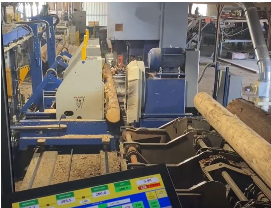
Figura 27 - Vista dall'interno di una cabina di comando di un impianto segatronchi. Il tronco sul carrello, tenuto fermo attraverso delle pinze idrauliche, viene indirizzato sulla lama della sega a nastro e tagliato a misura a seconda delle esigenze di produzione.
