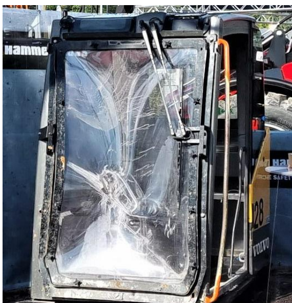
Figura 47 - Cabina di comando priva di griglia di protezione con parabrezza sfondato
