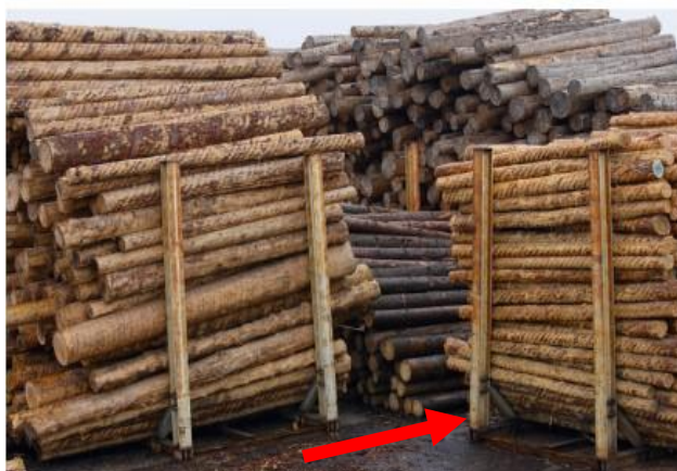
Figura 56 - Staffe metalliche per il sostegno laterale delle cataste
