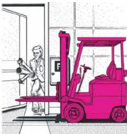
Figura 135 – Possibile inciampo o urto contro attrezzature posizionate in corrispondenza di porte e/o portoni.
