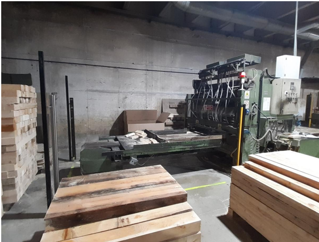
Figura 110 – Vista di una macchina chiodatrice per pallet. Il rischio derivante dal possibile contatto con elementi mobili ed in particolare il carro traslante viene gestito attraverso l'utilizzo di barriere fotoelettriche con relativi specchi. Le stesse determinano un perimetro tutto intorno alla zona di lavoro dimensionato in modo tale che l'operatore non possa rimanere al suo interno senza intercettare i raggi della barriera..
