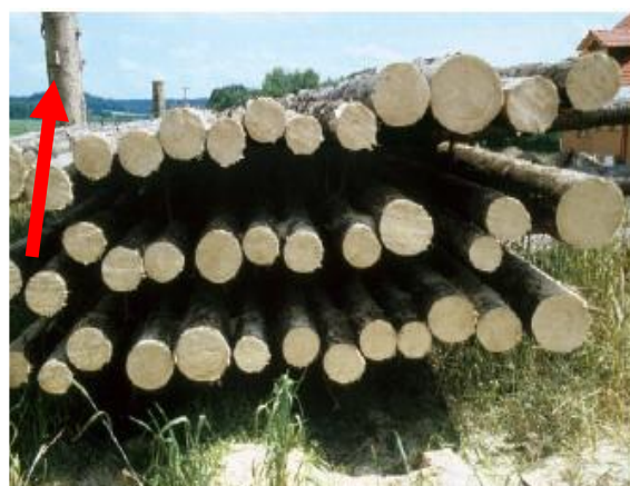
Figura 57 - Supporti in legno per il sostegno laterale delle cataste
