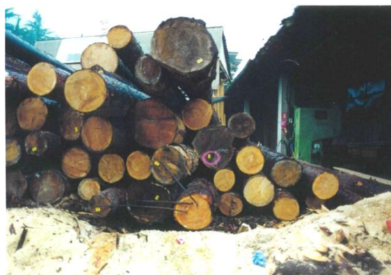
Figura 53 - Tronchi fermati con cambre
