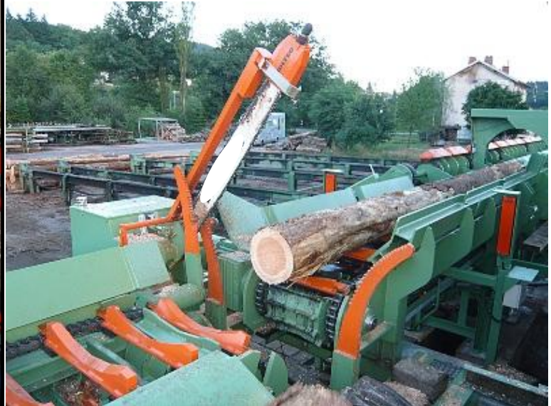
Figura 91 e 92- Intestatrice-troncatrice tronchi con lama a catena sgorbia orizzontale. Intestatrice-troncatrice tronchi con lama a catena sgorbia verticale
