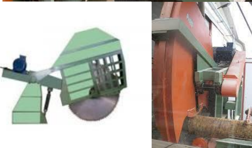
Figure 84-85-86 - Serie di lame circolari per intestatura tronchi con protezione diversificate del disco
