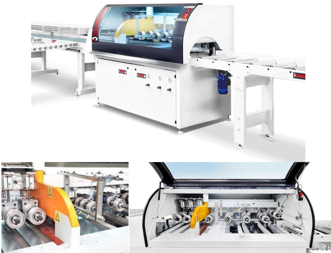
Figura 105 - Troncatrice automatica con disco di taglio dal basso, protezione della lama superiore e frontale fissa e cofanatura con dispositivi di interblocco (microinterruttore)
