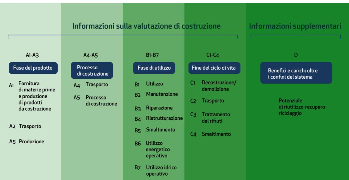
Figura 2. Moduli da A a D a seconda del processo analizzato. A1 per la fornitura di materie prime, A2 per il trasporto in fabbrica e Modulo D per i processi di riutilizzo e riciclo (fonte: EN 15804+A2).
